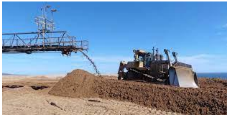
شکل ۲-۷- نحوه مسطح نمودن و کوبش باطله ناشی از فیلتراسیون
