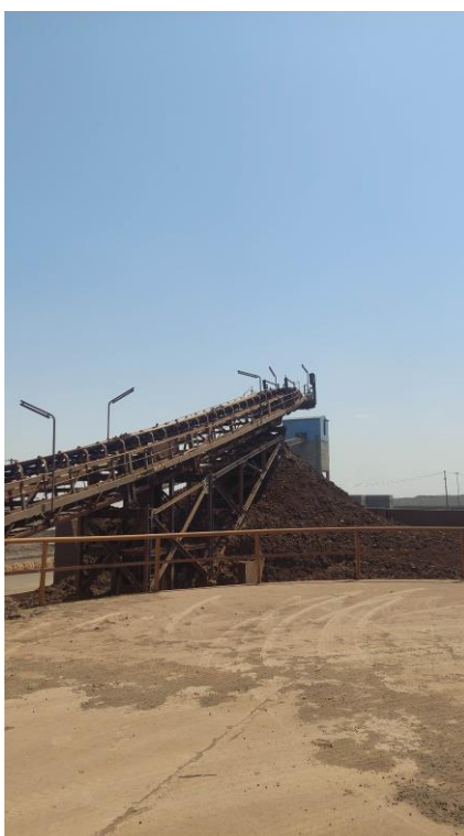
شکل ۲-۶- نحوه انتقال باطله تولید شده از فیلتراسیون
